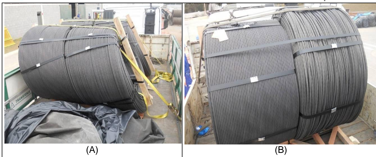
Figura 2: Não conformidade observada no recebimento de rolos de cordoalhas. (A) Rolo de cordoalha tombada no momento do recebimento e (B) Detalhe do desalinhamento do rolo de cordoalha.
