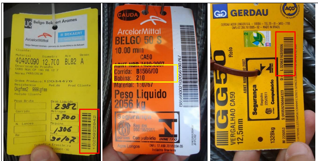
Figura 3: Etiquetas de identificação em rolos de aço fornecidos - detalhe do número da corrida para rastreabilidade do produto.
